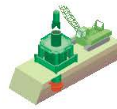
【低排土式】先行削孔工法
