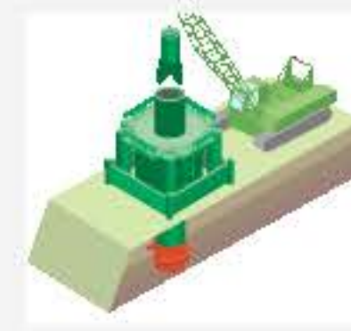
【低排土式】先行削孔工法
